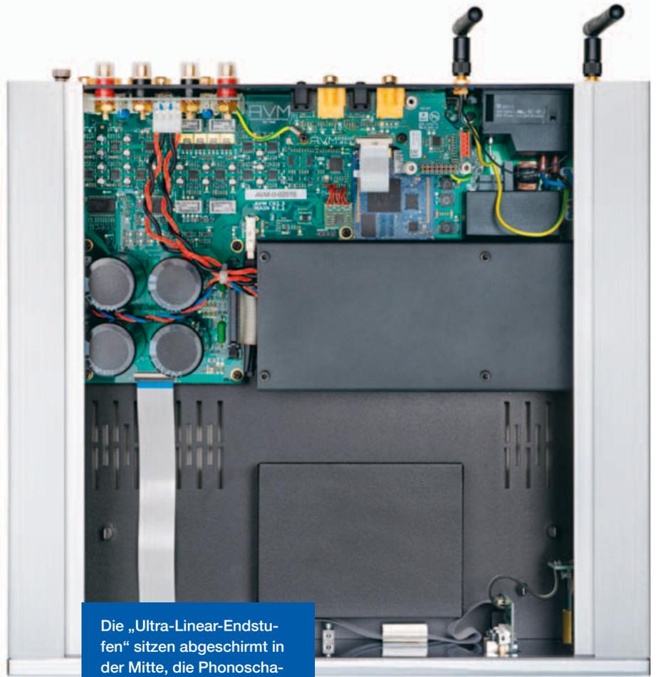
Die „Ultra-Linear-Endstufen“ sitzen abgeschirmt in der Mitte, die Phonoschaltung oben links, rechts daneben die Vorstufe.
