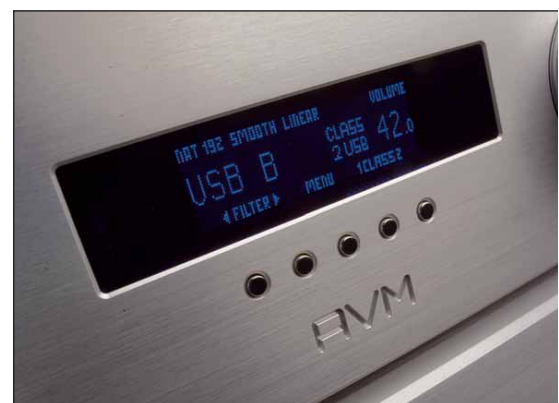
Abtastrate und Filter lassen sich mit den Bedientasten an der Front beliebig einstellen
