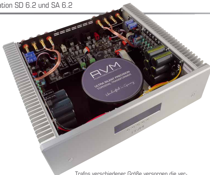
Trafos verschiedener Größe versorgen die verschiedenen Bauteile der Endstufe SA 6.2
