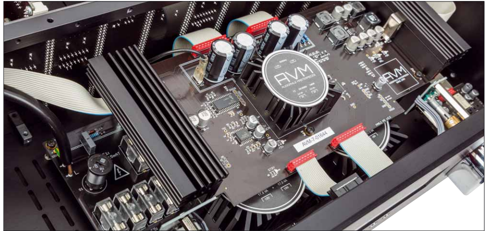
Für alle Fälle gerüstet: Das Netzteil des PA 6.2 versorgt mit drei Ringkerntrafos jede erdenkliche Modulkonfiguration
