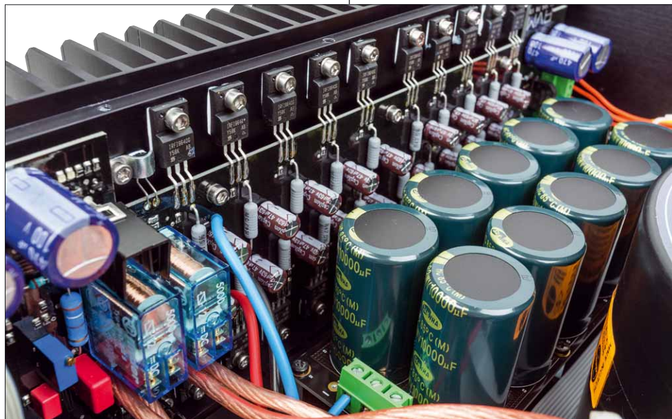
Leistung satt: 20 MosFets mobilisieren in der MA 6.2 ein Kilowatt Dauerleistung an vier Ohm
