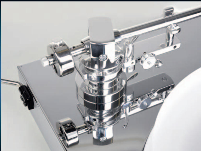
BIS INS KLEINSTE DETAIL: Der 10-Zoll-Tonarm wird kardanisch gelagert. Das Antiskating stellt man über ein Gegengewicht an der Basis ein.
