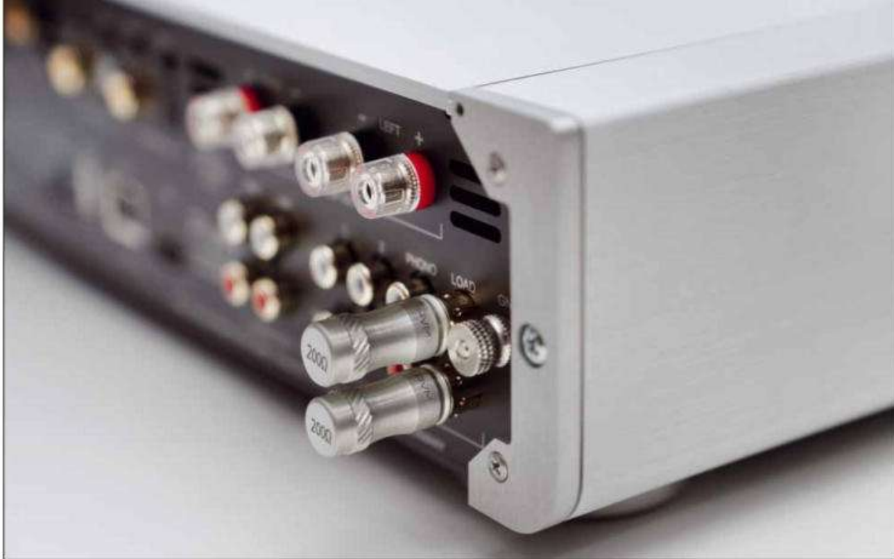
Im Vordergrund die Anpassungsstecker für die Phonostufe und im Hintergrund die neuen, „kleinen“ LS-Anschlüsse
